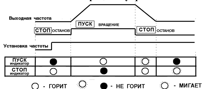
Рис. 11. Пояснения к пульту управления Изменение состояний световых индикаторов "ПУСК" и "СТОП" в процессе управления
